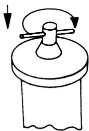
После полного вталкивания крышки повернуть рукоят-
