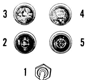
1. Выключатель сигнальной проверки
