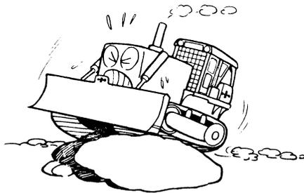
○ Нельзя выключать одну муфту поворота, чтобы проехать препятствие. Нельзя наезжать на препятствие под углом.
