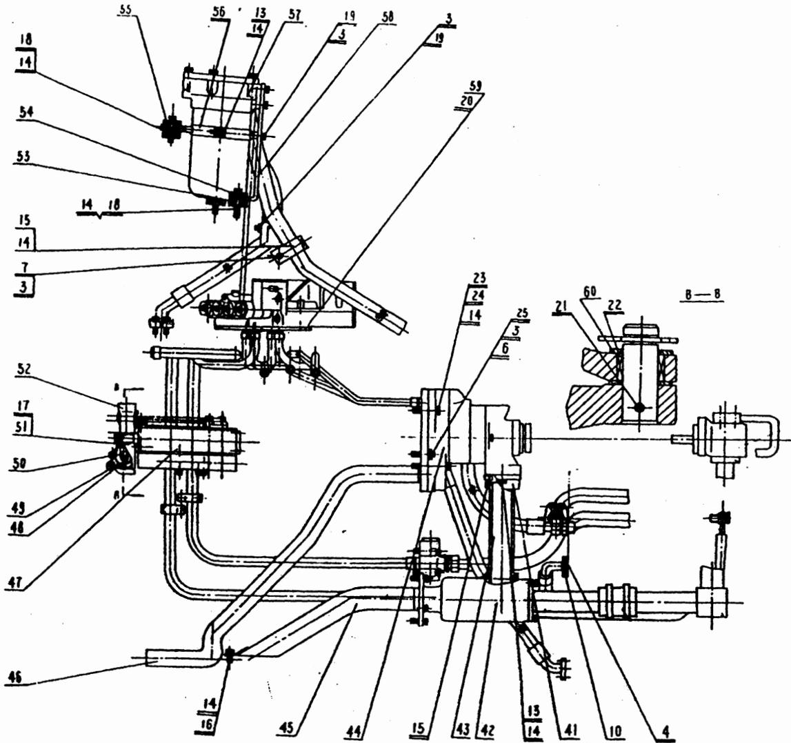
OT39000 底盘液压系统 Гидросистема шасси
