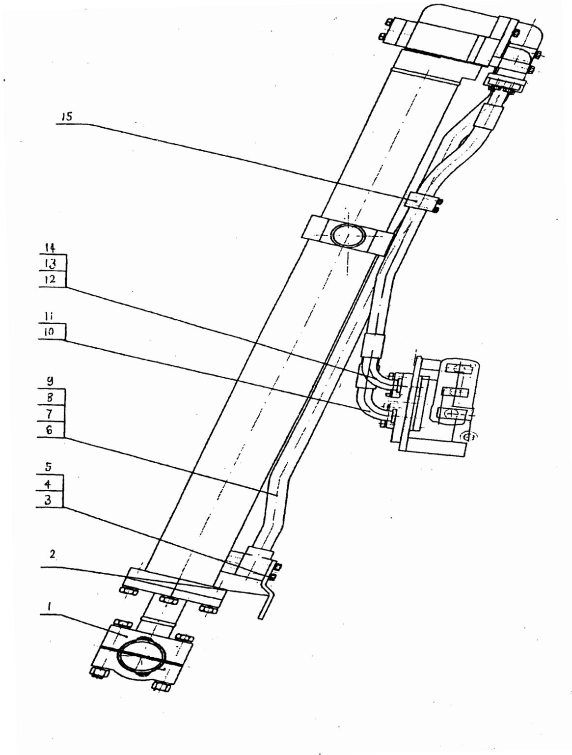
0T41000 提升油缸大总成 Гидроцилиндр подъема в сборе
