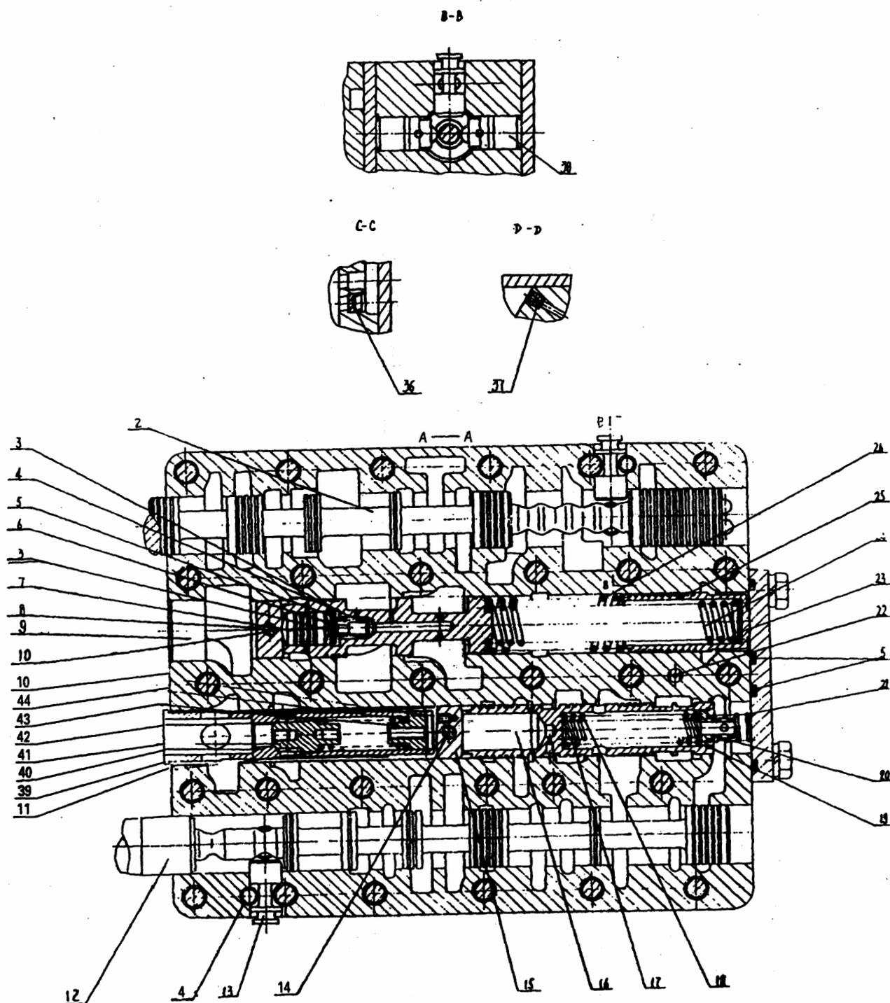
0T12150 变速箱控制阀 Клапан управления коробкой передач
