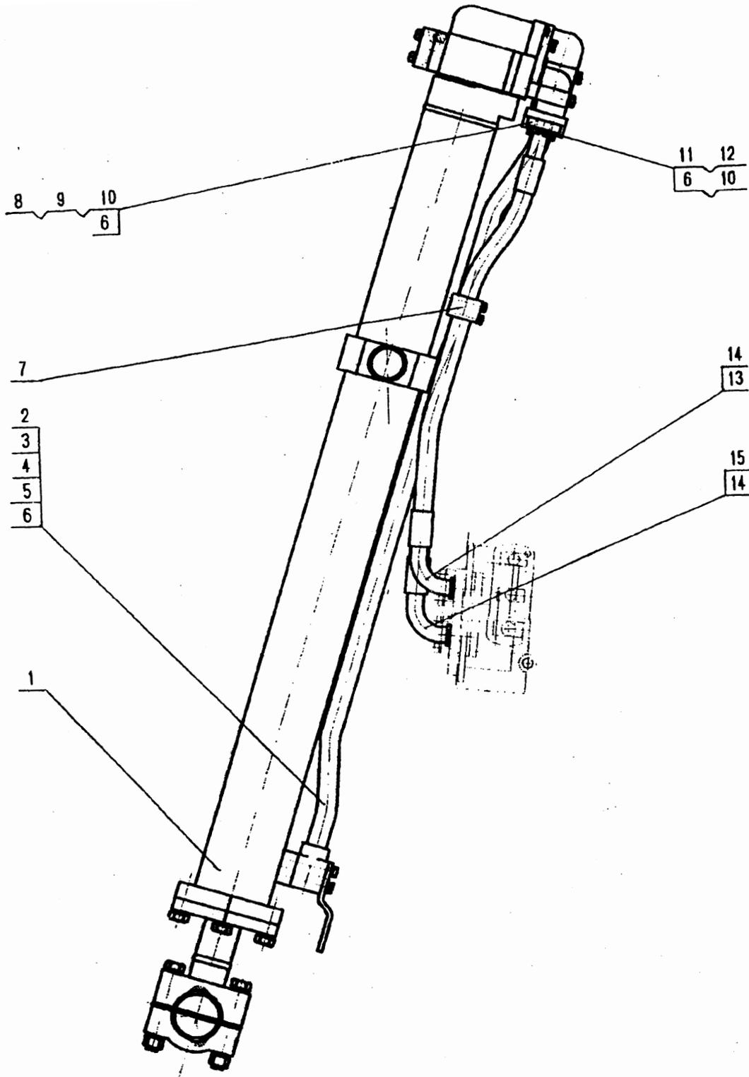
OT64000 提升油缸总成 Гидроцилиндр подъема в сборе
