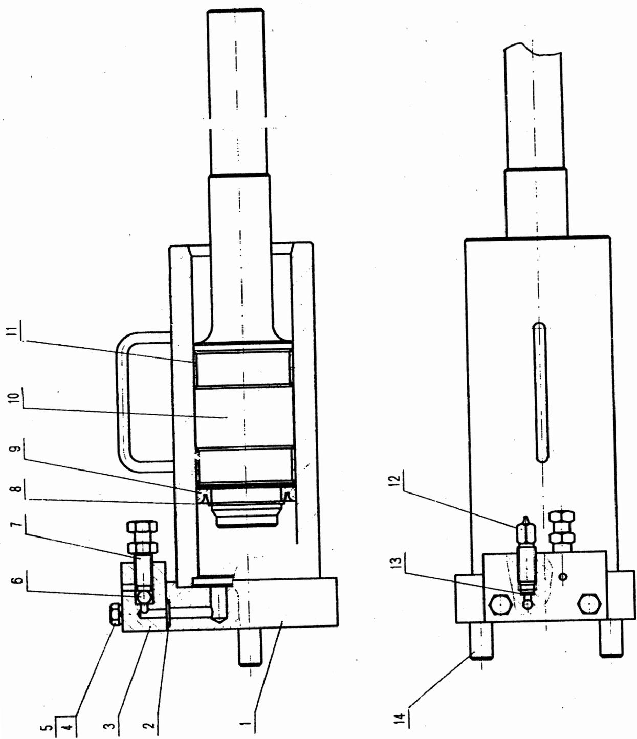
0T53009 履带左张紧装置 Левый Натяжной механизм гусеницы
