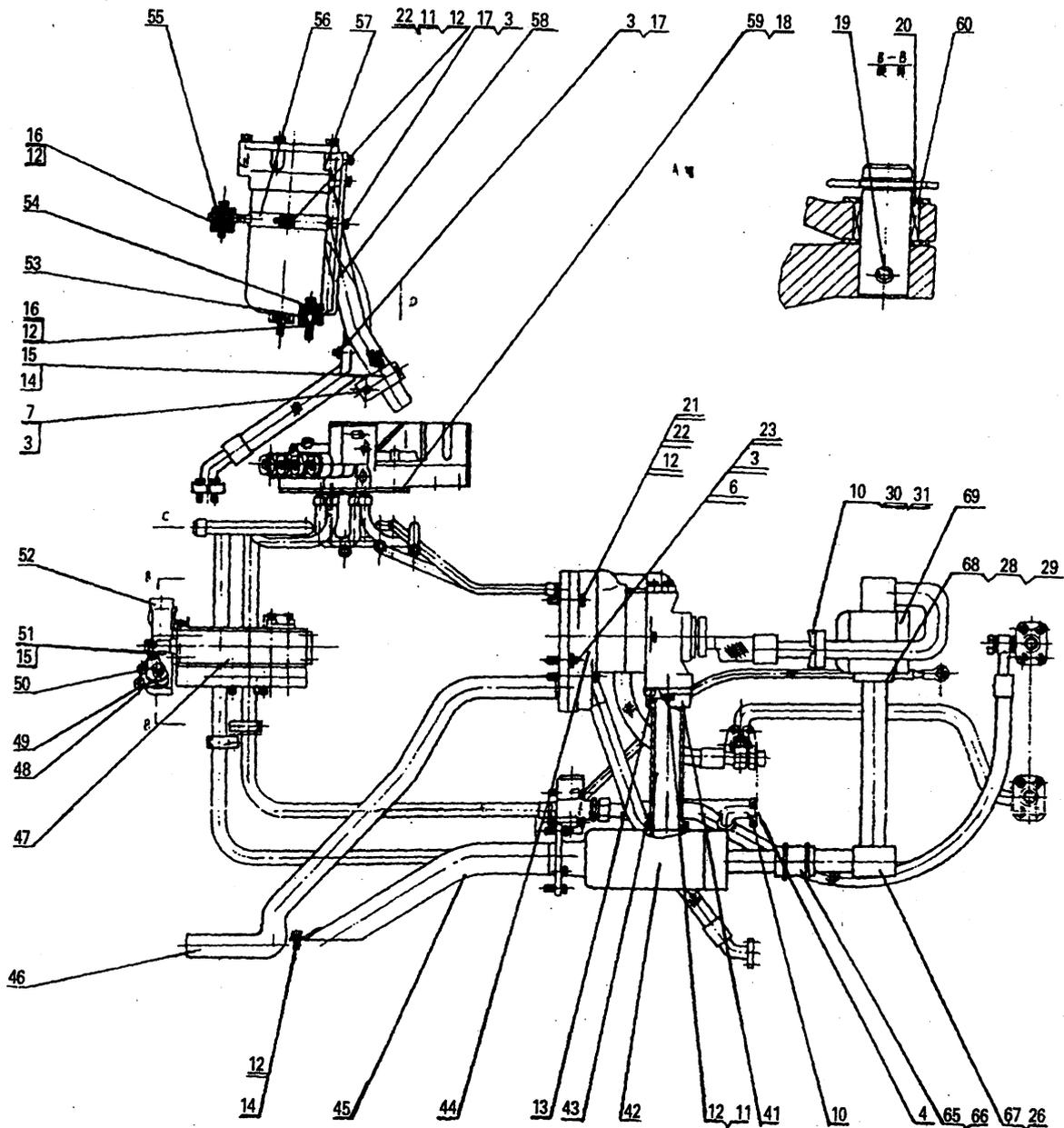
OT12000 底盘液压系统 Гидросистема шасси
