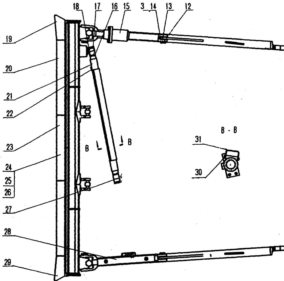
0T52000 推土装置 Бульдозерное оборудование
