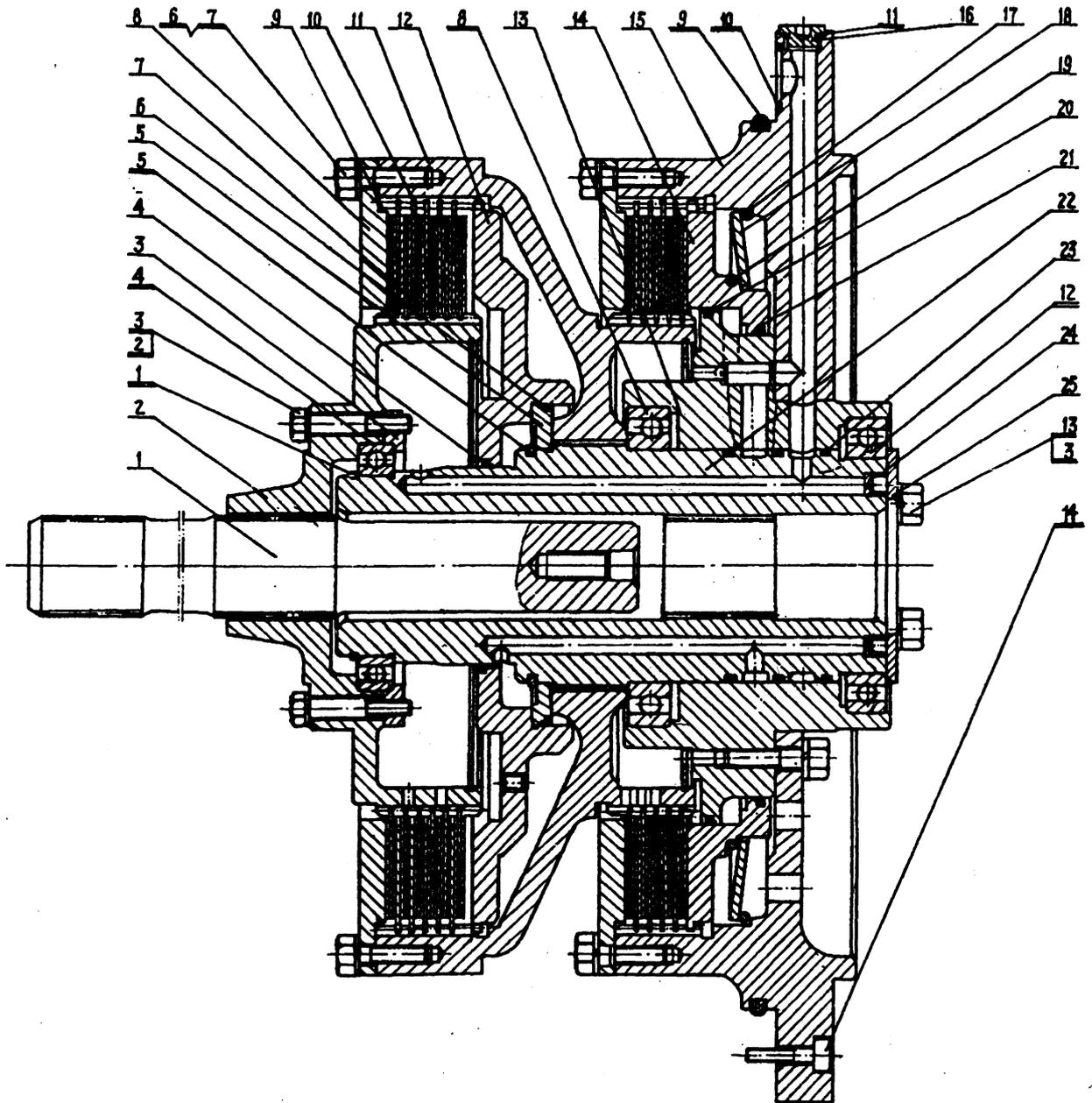
OT04000 转向与制动离合器 Бортовой и тормозной фрикционы
