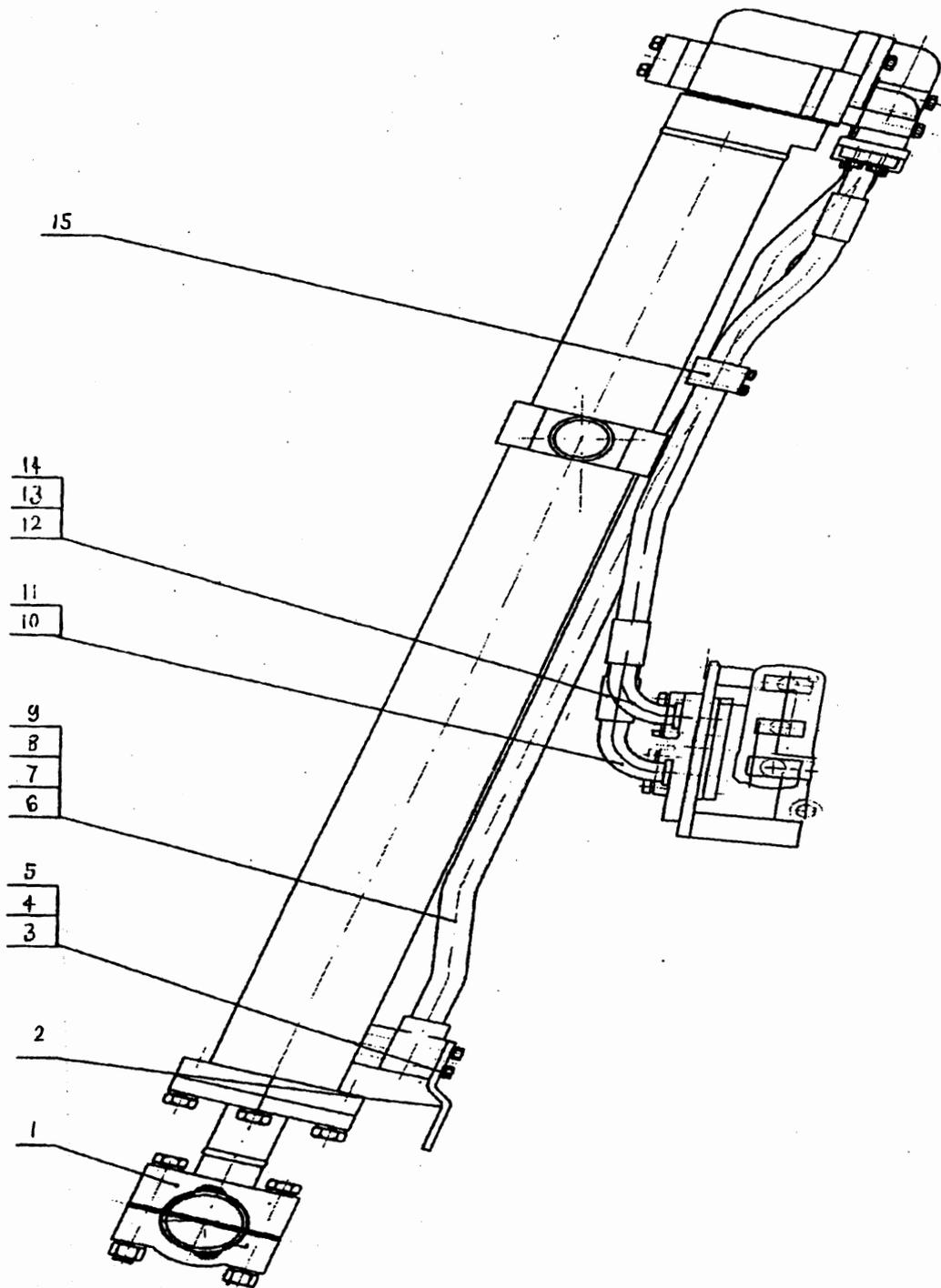
0T41014 提升油缸总成 Гидроцилиндр подъема в сборе
